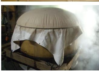
造る酒に合わせて精米した米を洗米・浸漬し、蒸し上げます。蔵人数人で手早く米を冷ました後は重要な工程である麹造り。時間をかけてもと(酒母)の仕込みをし、その後は醪(もろみ)仕込み、上槽、ろ過・火入れ、貯蔵と工程が続きます
